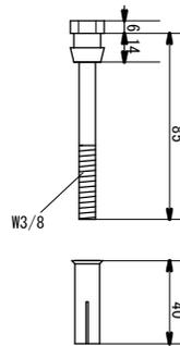
コンクリート舗装用アンカーピン
