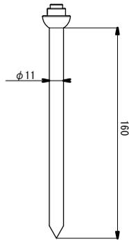
アスファルト舗装用アンカーピン
