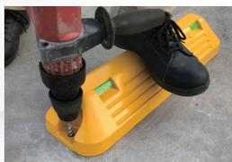
No.2 設置位置を測量し、設置面を掃除後、本体を定位置に置き押しつけながらピン位置にドリルで穴あけをします。
